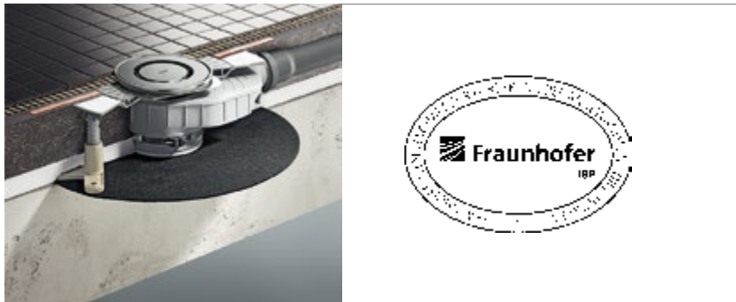
Abb. 277: Nicht nur die Schallentkopplung der Montagefüße ist wichtig. Durch die im Lieferumfang enthaltene Schallschutzmatte lassen sich sowohl die Funktionsgeräusche als auch der Trittschall erheblich reduzieren. Der Ablauf Advantix-Top erfüllt alle Schallschutzstufen nach der VDI-Richtlinie 4100.
